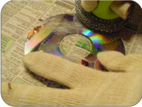
Figura 34: Rasgado de la parte frontal del disco Fuente: elaboración propia
