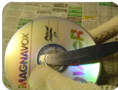
Figura 32: Separación de las dos láminas plásticas del disco Fuente: elaboración propia
