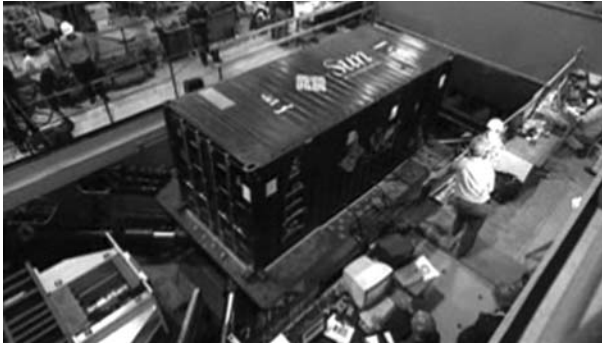
Fig. 3 Sun BlackBox S20 ante una simulación de un terremoto 6.7 en la escala Richter.
