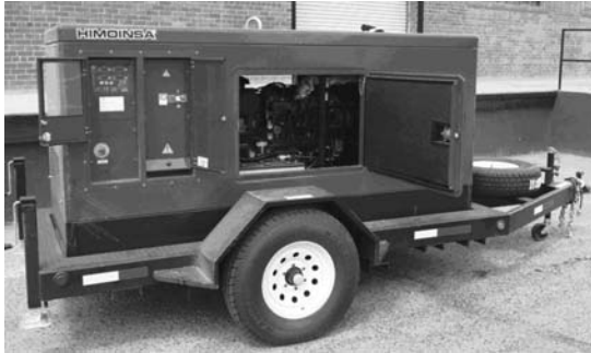
Fig. 17 Generador eléctrico Himoinsa de 338kVA con motor Iveco
