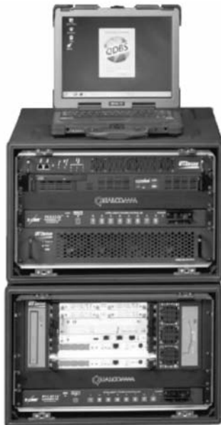
Fig. 12 Estación base celular desplegable de Qualcomm
