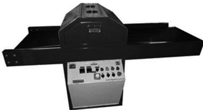
Fig. 2. Horno de secado y curado para tintas ultra violeta o UV. Fuente: Propia.
